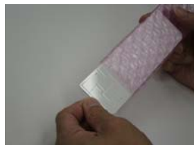
←NG 包装材のテープをほどかず、LED をスライドさせて抜くと LED が剥がれる恐れがあります。
